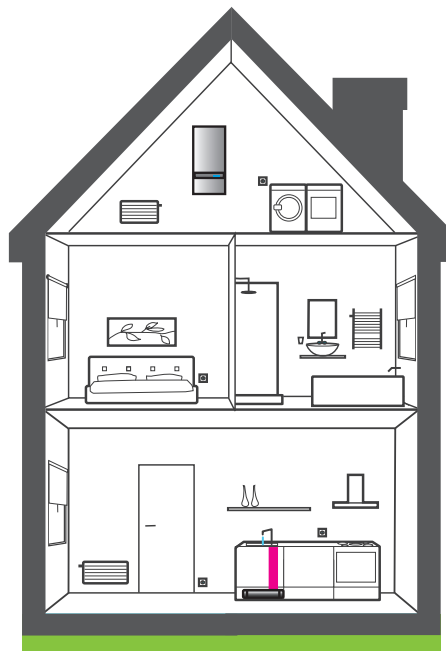
Woning met Close-in keukenboiler
